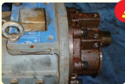
DSP本体に錆びが付着。ロックし緊急停止。
